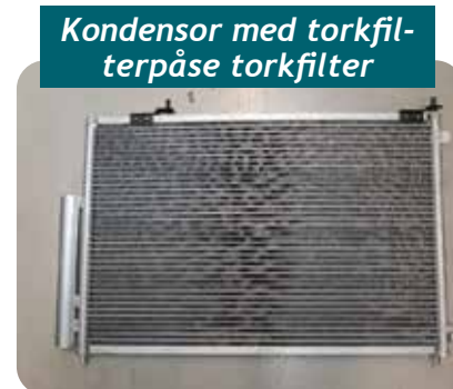
Kondensor med torkfilter
